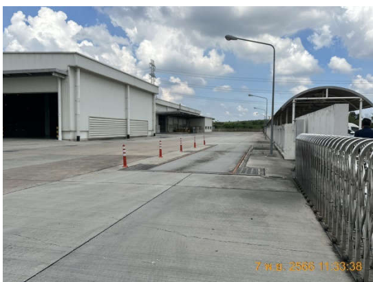
รูปถ่ายที่ 3.2-23 : เครื่องชั่งน้ำหนักรถบรรทุก
