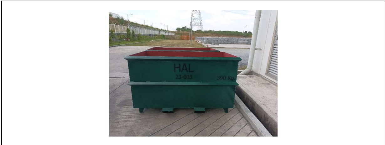
รูปถ่ายที่ 3.2-31 : ถังเหล็กขนาดใหญ่สำหรับเก็บรวบรวม Dross
